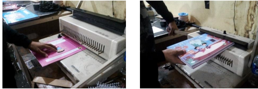
Gambar 4. 10 Proses Pemasangan Ring
