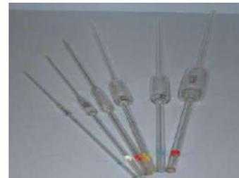
2. **Pipet ukur.** Pipet ini memiliki skala, digunakan untuk mengambil larutan dengan volume tertentu. Gunakan bulb atau karet penghisap untuk menyedot larutan, jangan dihisap dengan mulut.
